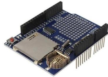
Figura 16: Módulo *Data Logger*
