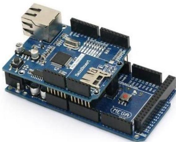
Figura 3. Placa Arduino Mega e *Shield Ethernet* conectadas.
