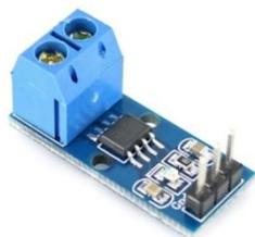
Figura 15: Módulo sensor de corrente ACS712
