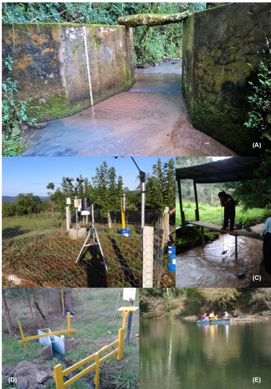
Figura 21. Estruturas para monitoramento hidrossedimentológico. (a) Calha Parshall no exutório da bacia hidrográfica do Arroio Lajeado Ferreira, (b) Estação de monitoramento das variáveis climatológicas (disdrômetro, estação meteorológica e pluviômetros), (c) Coleta de amostras de sedimento em suspensão, durante evento pluviométrico, (d) Calha Parshall na sub-bacia do Arroio Lajeado Ferreira, (e) Determinação da curva-chave de vazão e concentração de sedimentos em suspensão no Rio Guaporé.
