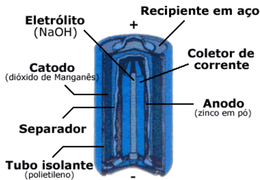
Figura 1 – Corte transversal de uma pilha convencional.
